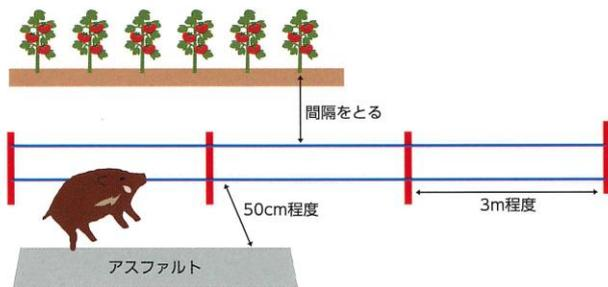
支柱の間隔は3m程度。柵線がたるむとショックが弱くなります。
