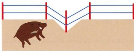
斜面途中で支柱を打つ時は斜面に垂直に下から落ちないようにしましょう。
